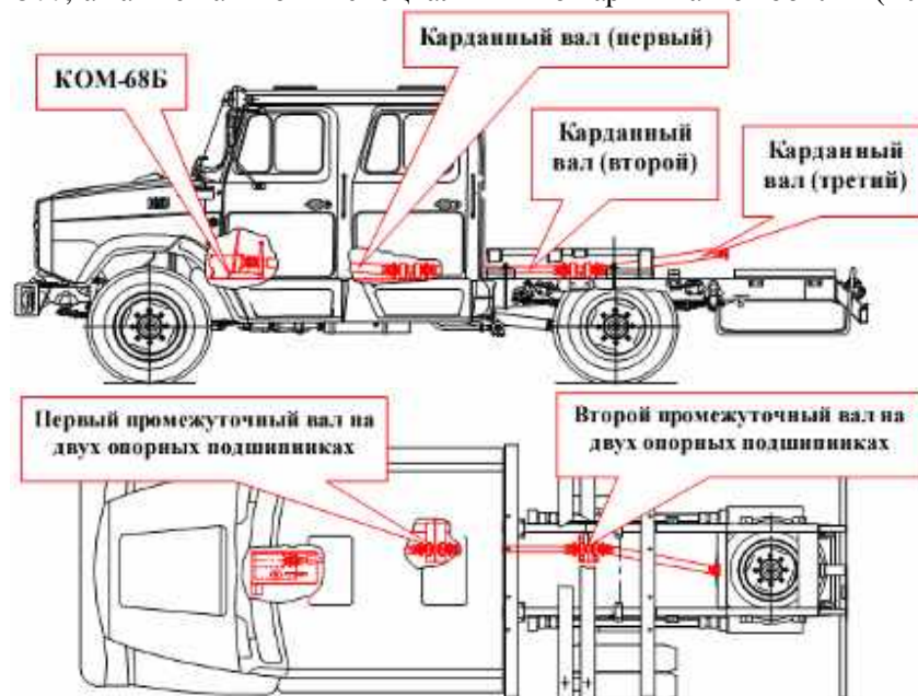
Рис. 2.46 Схема трёхвальной дополнительной трансмиссии автоцистерны АЦ-2,5-40(433362)ПМ-540
