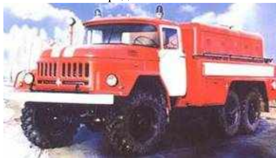
Рис. 2.13 Пожарная насосная станция ПНС-110(131)131А
