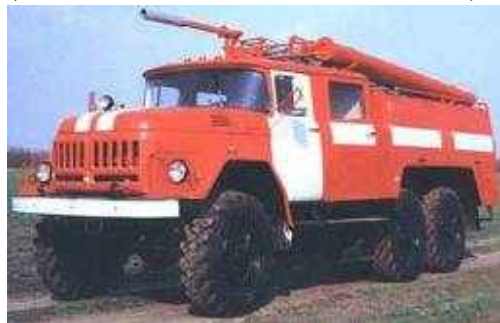
Рис.2.3. Пожарная автоцистерна АЦ-40(131)137А
