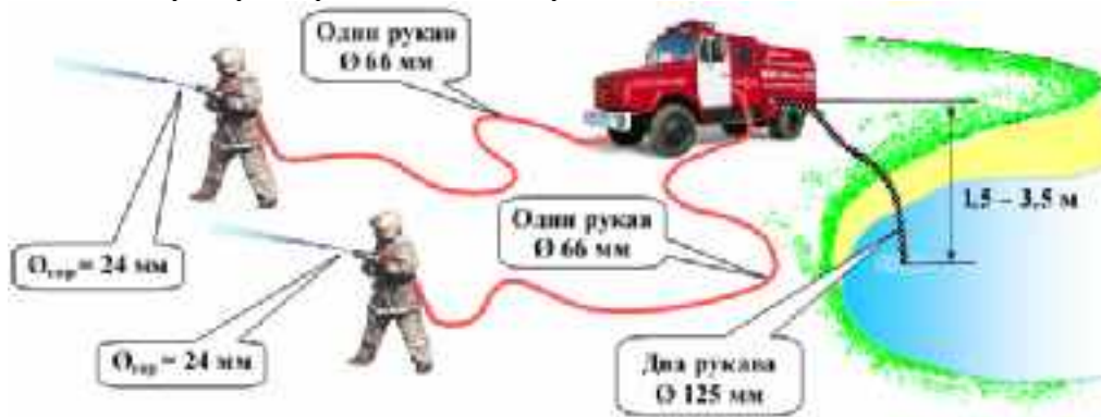
Рис. 7.4 Схема установки пожарного автомобиля для проверки пожарного насоса ПН-40УВ (НПЦ-40/100)
