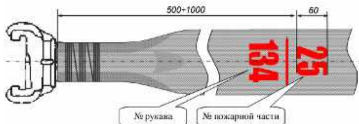
Рис. 5.3 Маркировка пожарного напорного рукава
