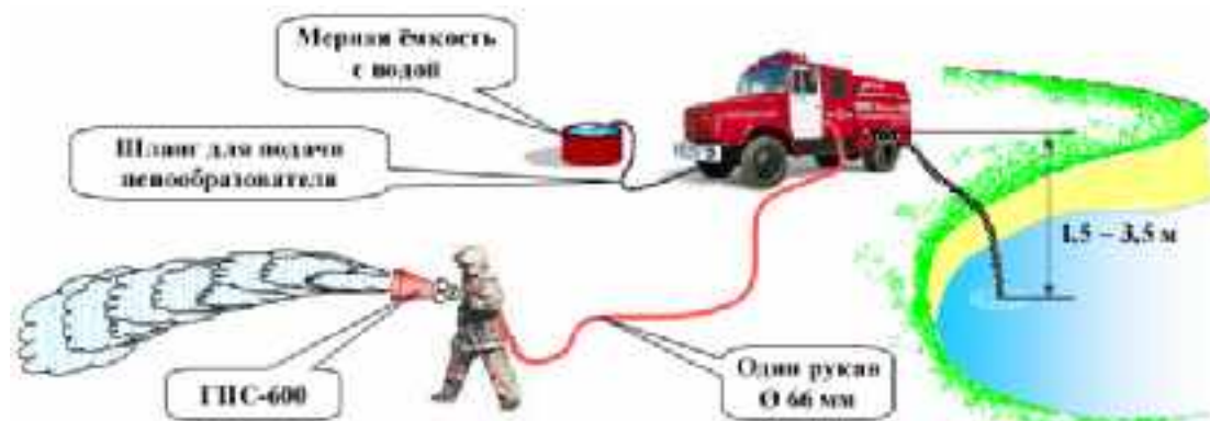
Рис. 7.5 Схема установки пожарного автомобиля для проверки пеноносителя ПС-5
