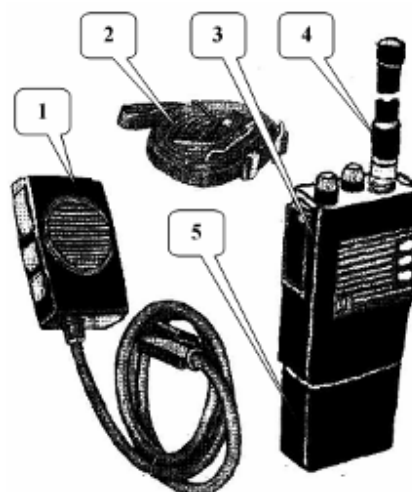
Рис. 6.7 Действующий комплект радиостанции «Сигнал-402А» 1 – манипулятор, 2 – ремень, 3 – приемопередатчик, 4 – антенна спиральная, 5 – батарея аккумуляторная.
