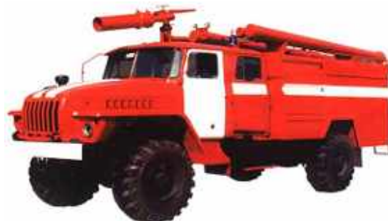
Рис.2.7.Пожарная автоцистерна АЦ-3,0-40(43206)1МИ
