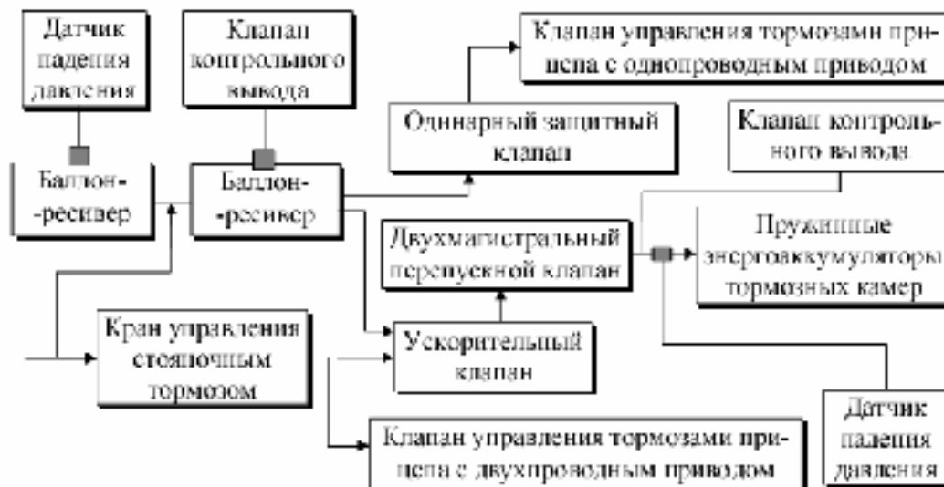
Рис. 9.11 Принципиальная схема работы привода механизмов запасного и стояночного тормозов
