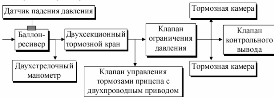
Рис. 9.9 Принципиальная схема работы привода механизмов рабочей тормозной системы передней оси
