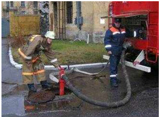
Рис. 5.37 Установка автоцистерны на гидрант
