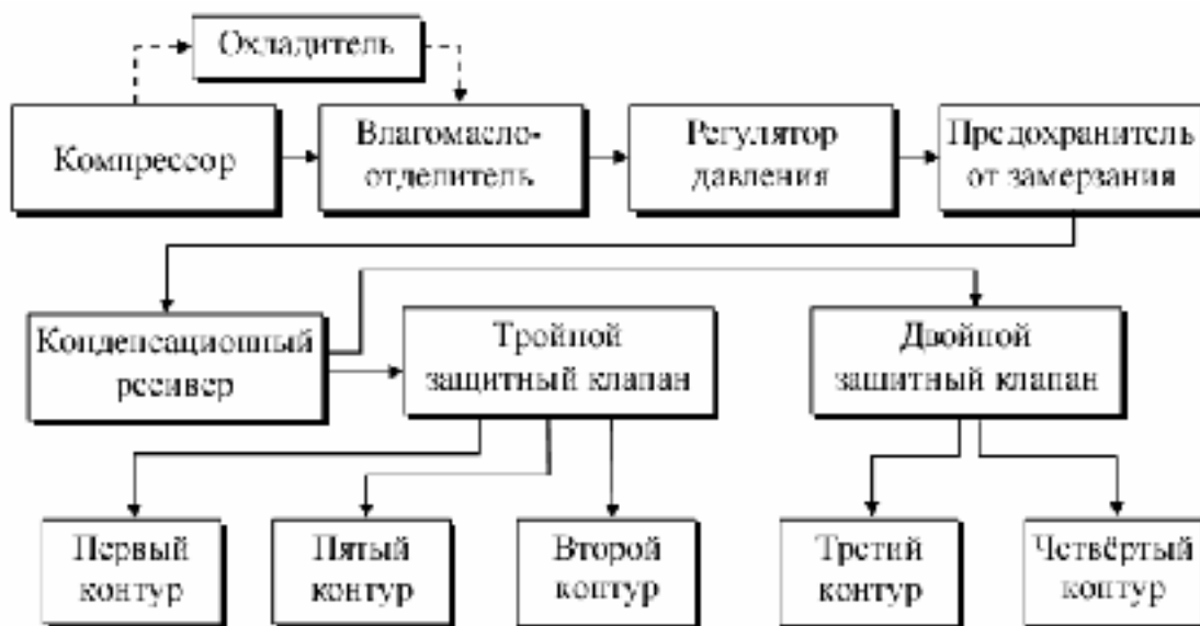
Рис. 9.8 Принципиальная схема работы питающей части пневмопривода
