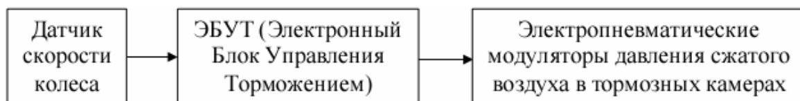
Рис. 9.14 Принципиальная схема функционирования АБС автомобиля с пневматическим приводом тормозных механизмов
