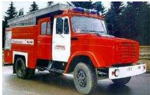
Рис.2.4. Пожарная автоцистерна АЦ-2,5-40(433362)ПМ-540
