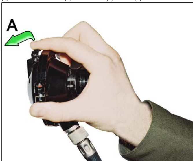
Рис. 2.82. Способ перекрытия легочного автомата при проверке звукового сигнализатора
