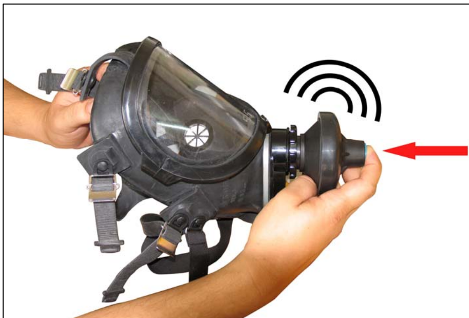
Рис. 2.52. Проверка устройства дополнительной подачи воздуха
