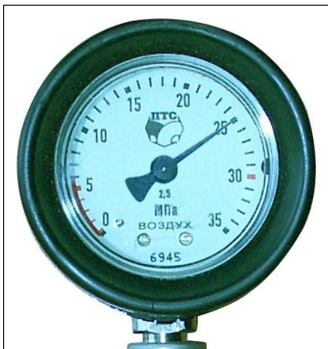
Рис. 2.33. Проверка давления в баллоне
