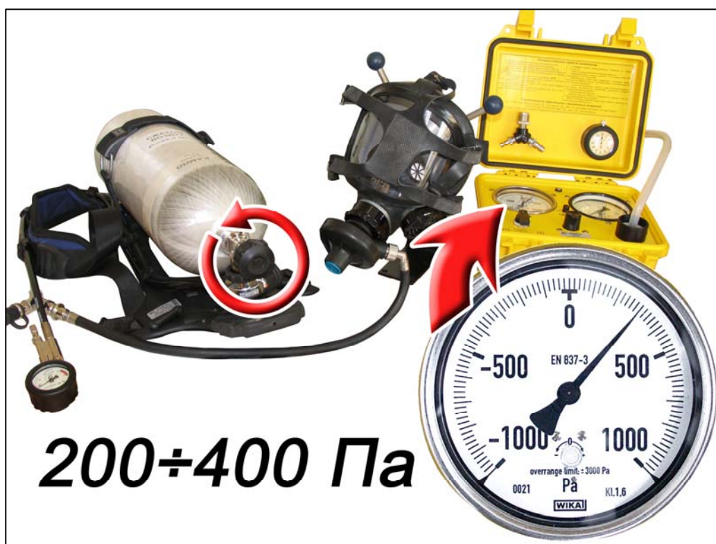
Рис. 2.56. Проверка подмасочного давления
