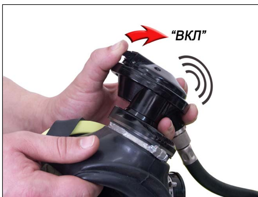
Рис. 2.31. Проверка устройства дополнительной подачи воздуха
