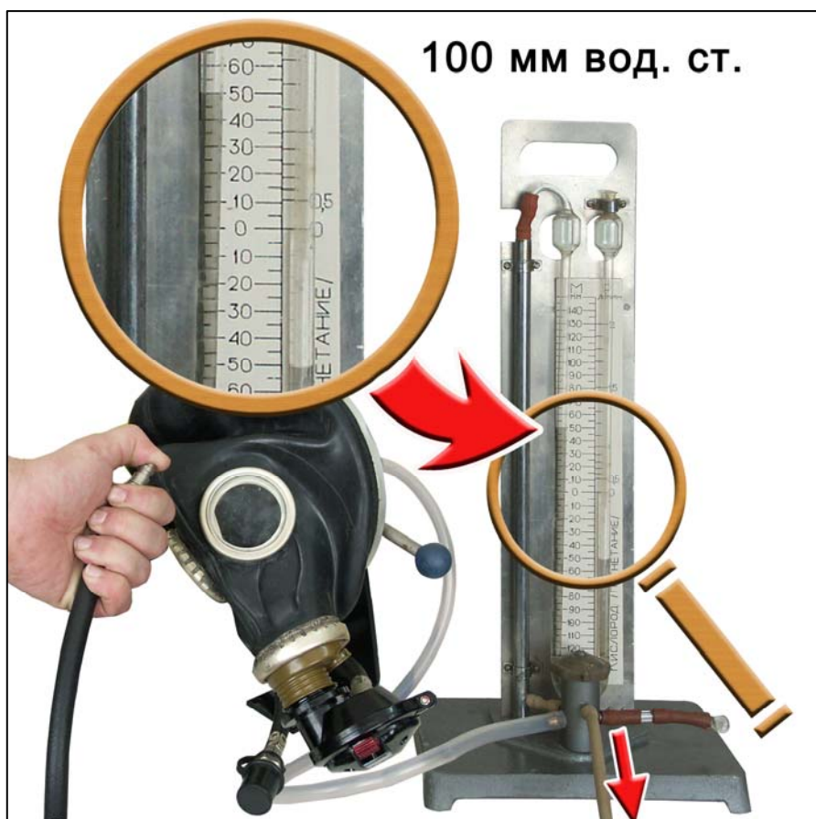
Рис. 2.38. Проверка герметичности воздуховодной системы спасательного устройства
