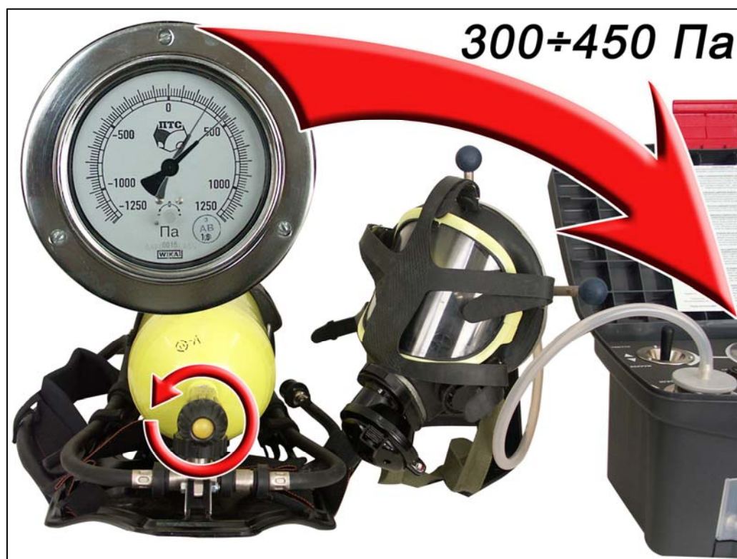
Рис. 2.23. Проверка механизма подмасочного давления
