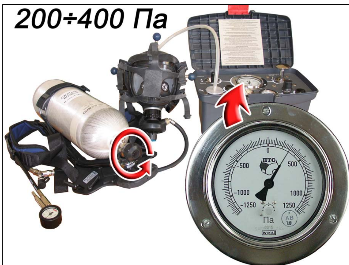
Рис. 2.50. Проверка исправности легочного автомата газодымозащитника
