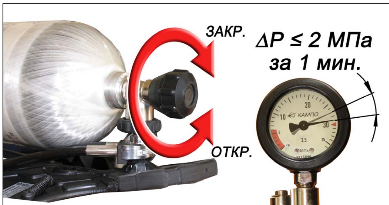
Рис. 2.44. Проверка герметичности системы высокого и редуцированного дав-
