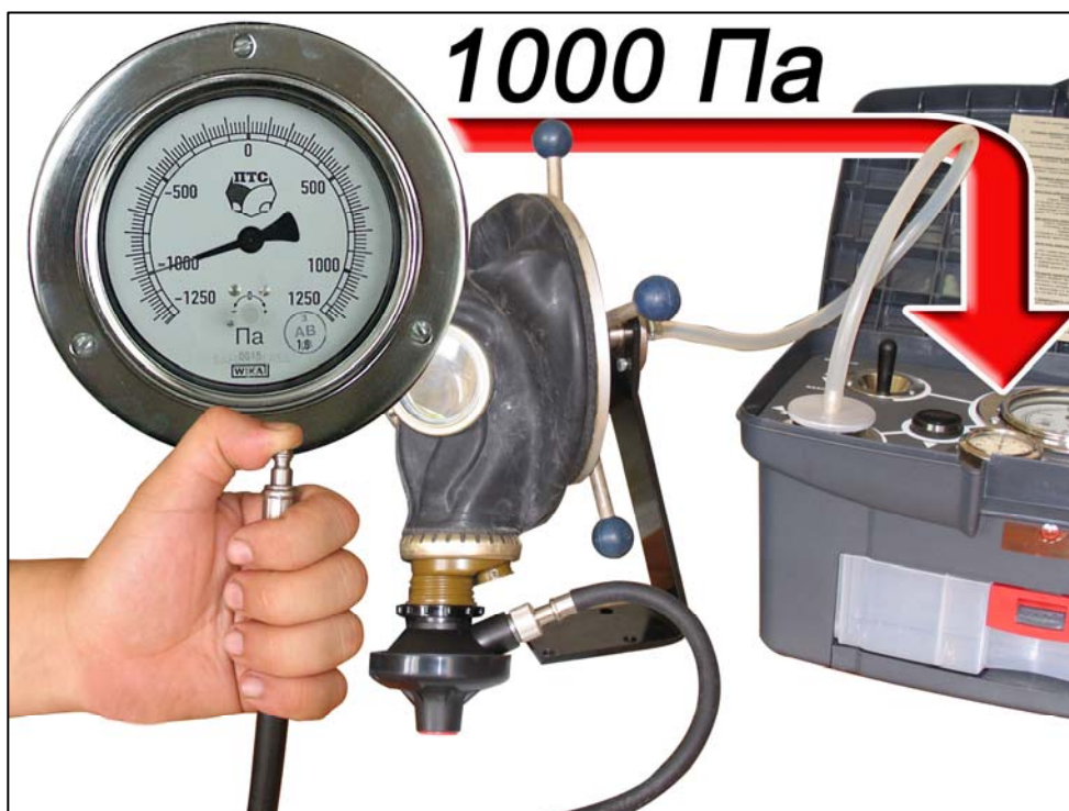
Рис. 2.49. Проверка герметичности воздуховодной системы спасательного устройства
