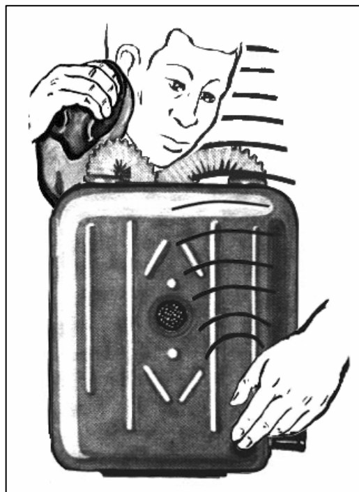
Рис. 2.21. Проверка аварийной подачи
