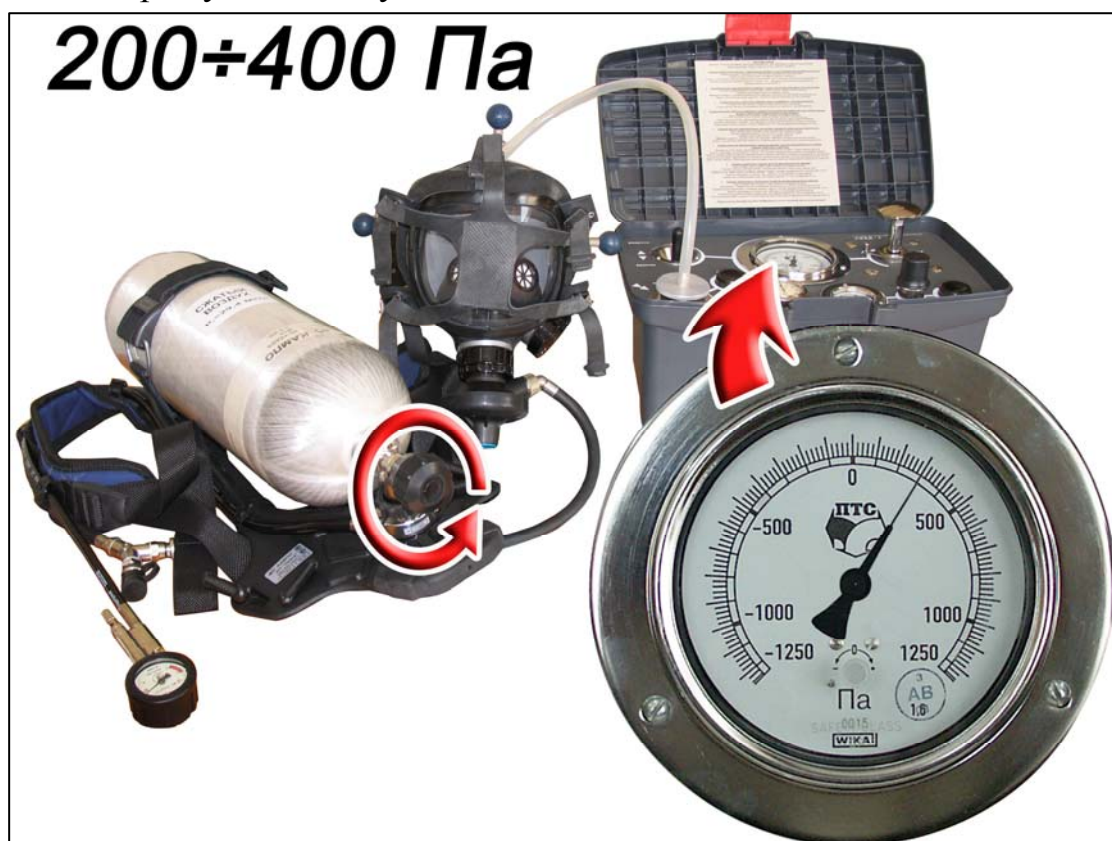
Рис. 2.43. Проверка подмасочного давления
